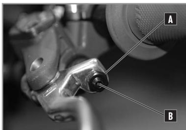
La tensión de la palanca del embrague se ajusta con la varilla roscada **B**.
