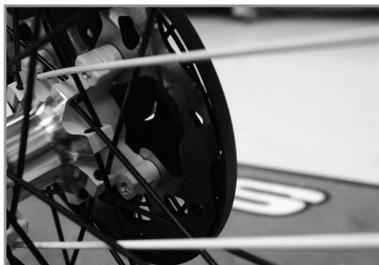
L'usure de l'épaisseur des disques se produit dans la zone de contact entre le disque et les plaquettes de frein.
