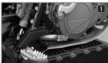
Das Hinterradbremspedal **1** befindet sich vor der rechten Fußraste.
