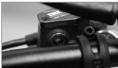
El depósito del líquido del freno delantero se encuentra junto a la palanca. Incorpora una pequeña mirilla que permite controlar el nivel del líquido.
