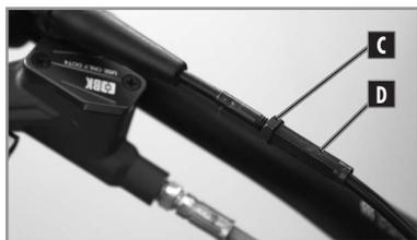
La tolerancia del cable del acelerador está ajustada de fábrica, pero el usuario puede modificarla.
