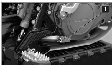
El pedal del freno trasero **1** está situado delante del reposapiés derecho.
