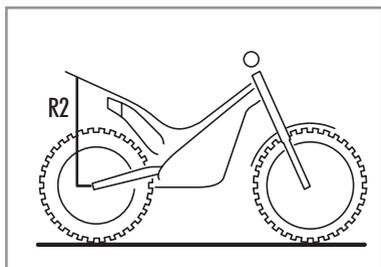
**$R1 - R2 =$  Hundimiento estático del amortiguador.**
