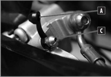
Zum Entlüften der Bremsflüssigkeit der Hinterradbremse:
