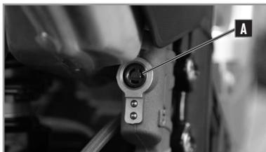
Der Bremsflüssigkeitsbehälter befindet sich direkt am Hauptbremszylinder.
