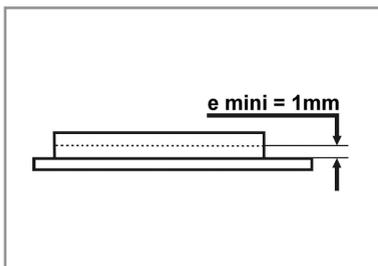
Der Verschleiß der Bremsbeläge tritt im Kontaktbereich zwischen Bremscheibe und Bremsbelägen auf.
