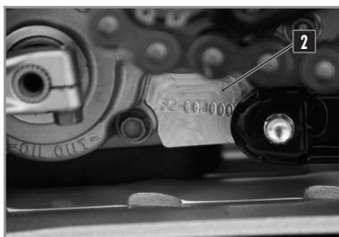
**2** Le numéro d'identification du moteur se trouve sur le côté gauche du carter, à côté du selecteur de vitesses.
