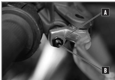
La tensión de la palanca del freno delantero se ajusta con la varilla roscada **B**.
