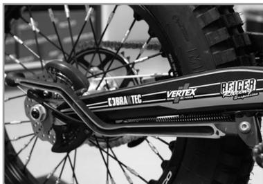
La béquille est située derrière le repose-pied droit. Elle est munie d'un ressort pour en faciliter le pliage.
