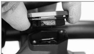
Der Kupplungsflüssigkeitsbehälter befindet sich unter dem Hebel.
