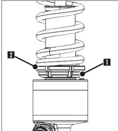
Zum Einstellen der Federvorspannung die Kontermutter **1** lösen und anschließend die Mutter **2** hinein- oder herausdrehen.
