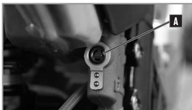
El depósito de líquido de frenos se encuentra directamente en la bomba de freno.
