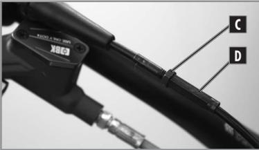
Obwohl die Toleranz des Gaszuges werkseitig eingestellt ist, kann der Nutzer sie anpassen.
