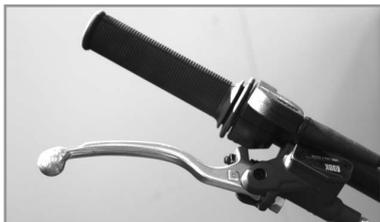
Der Vorderradbremsehebel befindet sich am rechten Griff des Lenkers.
