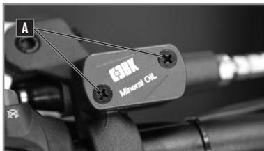
El depósito del líquido del embrague se encuentra sobre la palanca.
