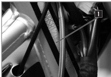
**1** El número de identificación del bastidor se encuentra en el lado derecho de la columna de dirección.
