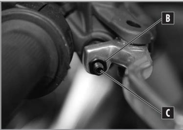
Die Position des Hebels muss unbedingt der Fahrergröße angepasst werden, damit er beim Kuppeln richtig gedrückt werden kann.
