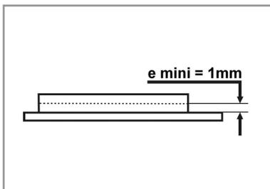
L'usure de l'épaisseur des plaquettes se produit dans la zone de contact entre le disque et les plaquettes de frein.
