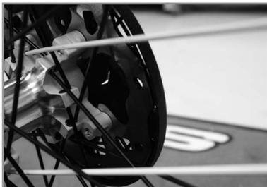
Der Verschleiß der Scheibenstärke tritt im Kontaktbereich zwischen Bremscheibe und Bremsbelägen auf.
